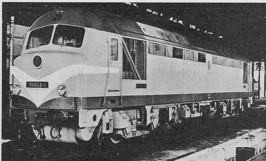
Bild 17. Lokomotive von 2400 PS mit zwei Freikolben-Gruppen
