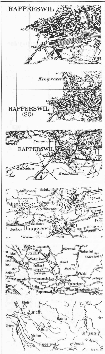
Bild 3. Landeskarte. Lückenlose Massstabsreihe: 1: 25 000, 1: 50 000, 1: 100 000, 1: 200 000, 1: 500 000 und 1: 1 000 000. Für Basiskarten geeignet ist das hier dargestellte lineare Bild, ungeeignet jedoch die im Buchhandel erhältliche mehrfarbige Ausführung.
