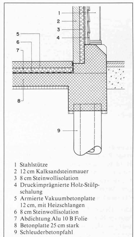
Bild 14. Fassaden- und Bodendetails Betriebsgebäude
