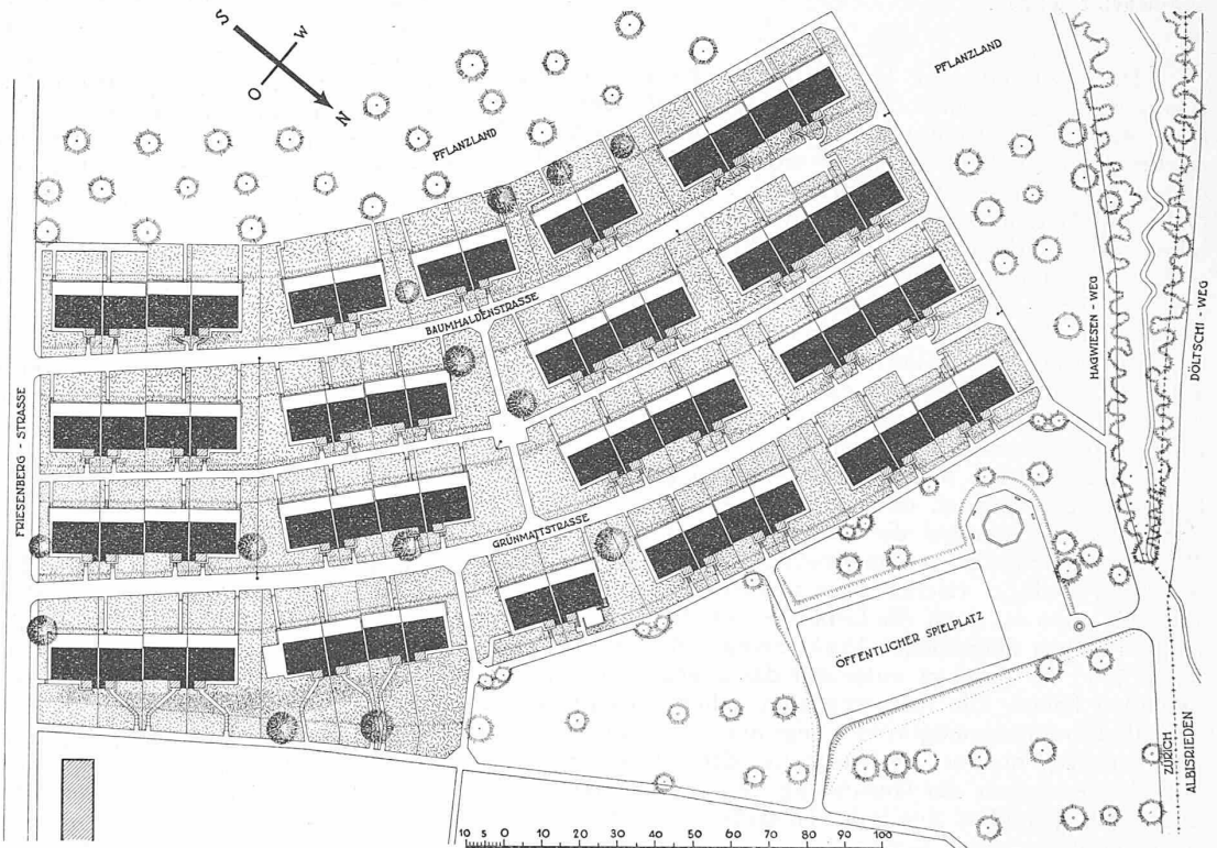
Abb. 1. Lageplan der Kleinhäuser am Friesenberg von Kessler & Peter, 3. Etappe der Familienheim-Genossenschaft Zürich. — 1 : 2000.
