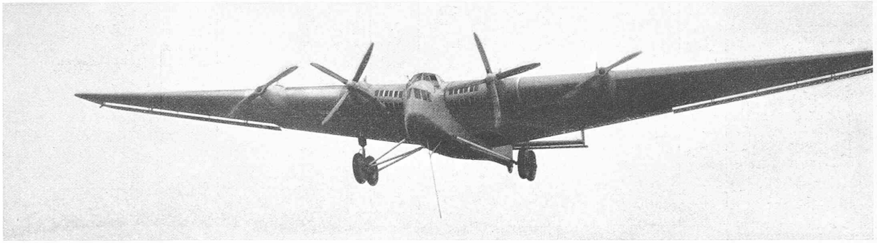
Abb. 15. Junkers Landflugzeug G 33, Länge 23 m, Spannweite 44 m, Nutzladung 11 t, gesamte Motorenleistung 2400 PS.
