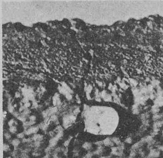
Imprägnierung mit Silikon-Bautenschutzmittel verhindert das Eindringen von Wasser, auch über Risse. Oben: nicht imprägniert. Unten: Silikon-imprägniert
