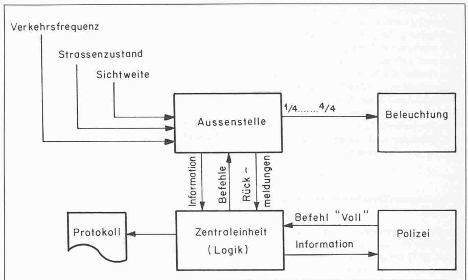
Bild 4. Übersichtsschema des Befehls- und Informationsflusses der Steuerung
