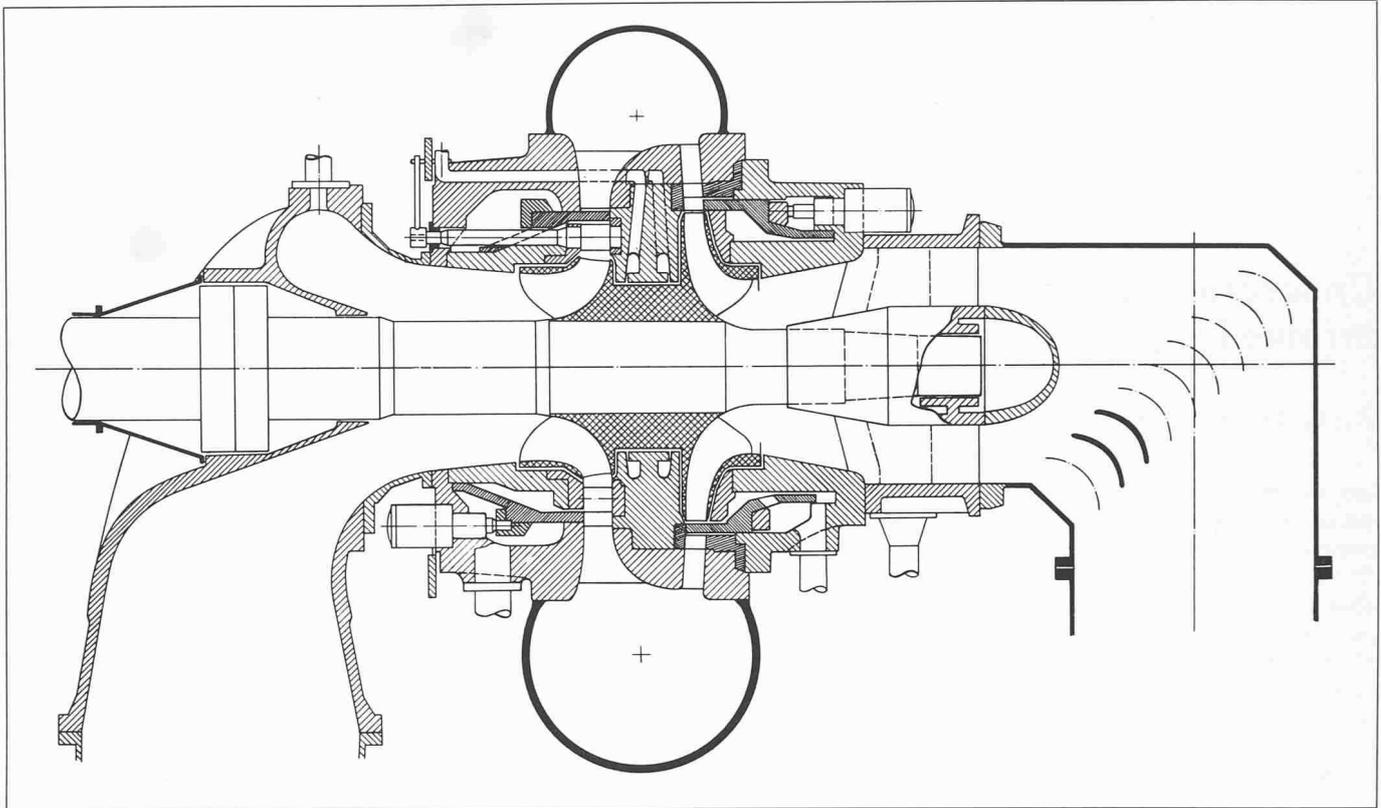
Fig. 1 Coupe longitudinale du groupe pompe-turbine Isogyre
