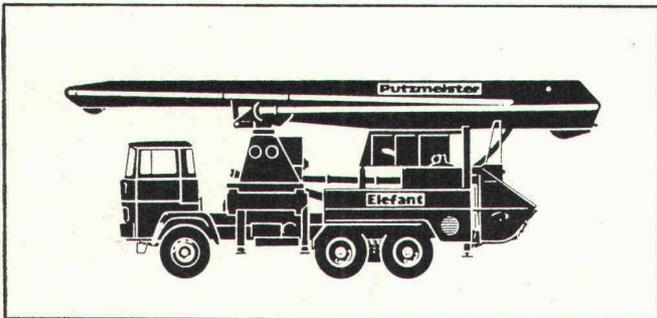
PUTZMEISTER Geräte werden als Autopumpen, Anhängerpumpen und stationäre Pumpen mit Leistungen zwischen 20 und 145 m<sup>3</sup>/h und Pumpendrücker zwischen 34 und 260 bar gebaut. Konstruktives Charakteristikum ist das pat. PUTZMEISTER Rüsselsystem mit der einzigartigen Rohrweiche, die dank einem selbst nachstellenden Automatikring die Trennstelle zwischen Rohrleitung und Betonförderzylinder hermetisch abdichtet.
