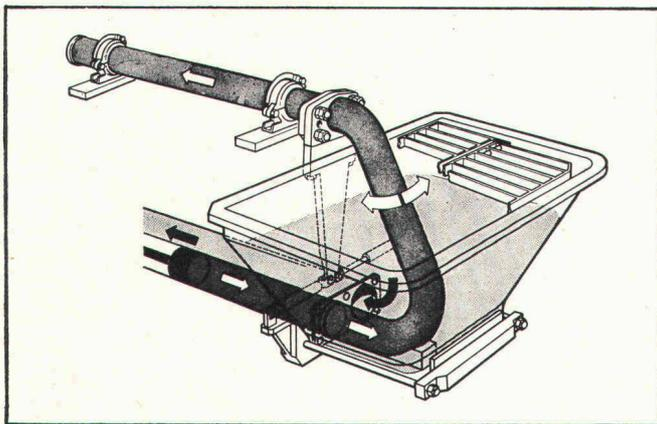
Verschiedene Pumpenzylinder-Hublängen und Zylinderdurchmesser, Diesel- oder Elektroantrieb, ermöglichen im Baukastensystem den Bau von Betonpumpen für jeden Bedarfsfall.
