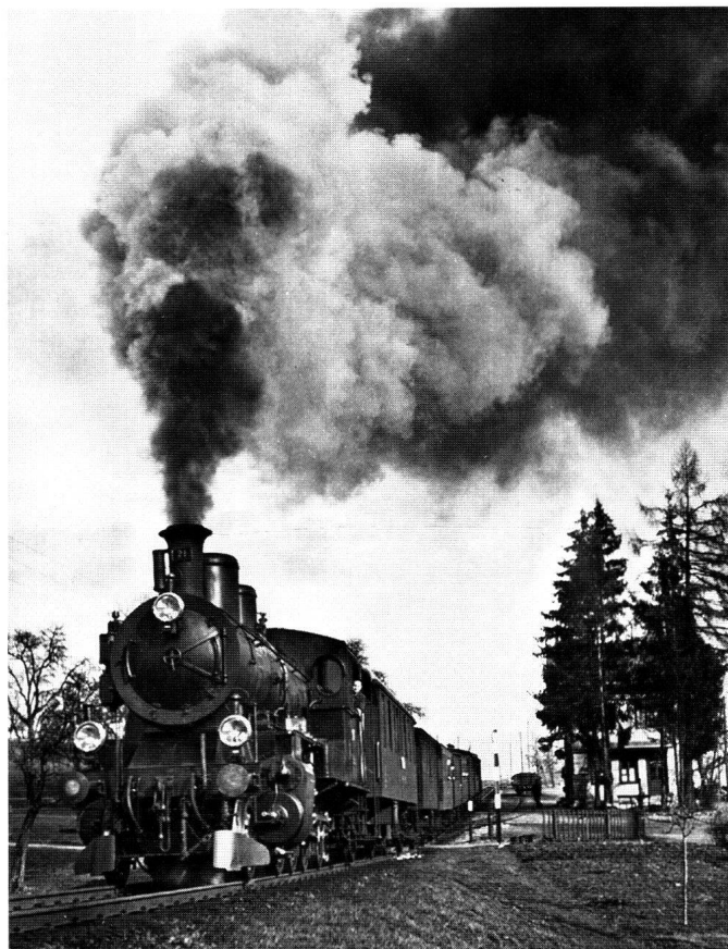
Abb. 1: Personenzug in Richtung Biberbrugg beim Beginn der Steilrampe nach der Station Burghalden. Dem Zug ist eine Dampflokomotive vom Typ E 4/5 vorgespannt, die erste Heissdampflokomotive der Südostbahn, die 1910 von der Lokomotivfabrik Winterthur abgeliefert und in Betrieb genommen wurde, im Hinblick auf den Mehrverkehr nach der Eröffnung der Rickenbahn von Uznach nach Wattwil. Ausrangierung 1940.
