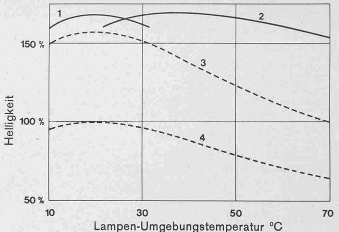
Das Diagramm zeigt den über einen weiten Temperaturbereich möglichen Helligkeitszuwachs: 1 LUMILUX, 2 LUMILUX <In>, 3 bisherige Standard-Lichtfarben, 4 bisherige de Luxe-Lichtfarben.
