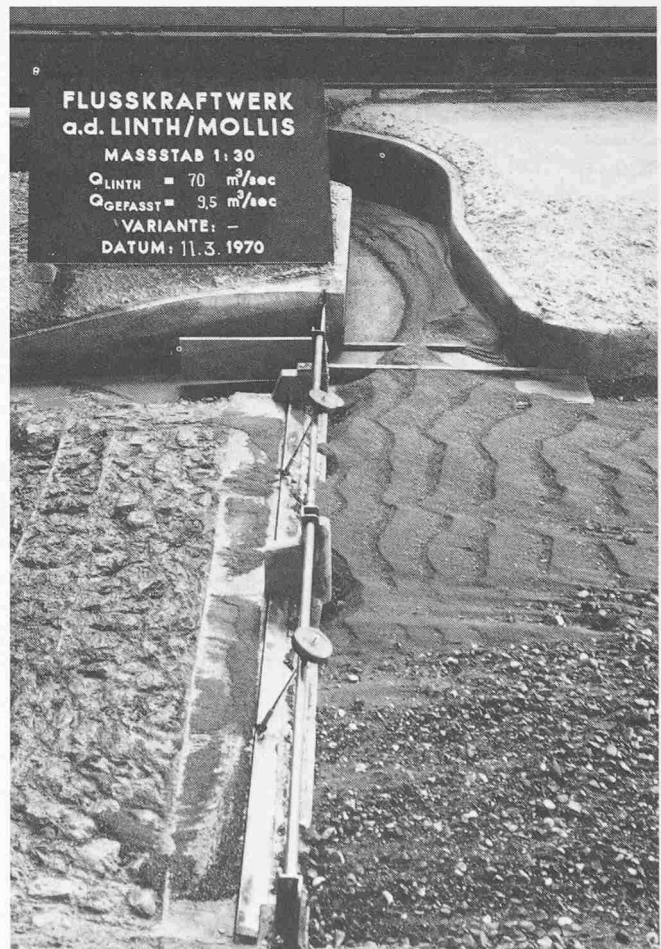
Bild 6. Bei bestehender Fassungsanlage starkes Eindringen von Geschiebe
