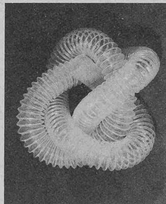
Maag löst Ihre diesbezüglichen Probleme dank extrem kleinen Biegeradien! Dieser neue flexible «Wunderschlauch» aus FEP TEFLON® ist ähnlich wie PTFE fast absolut chemisch beständig, einsetzbar in einem Temperaturbereich zwischen -50 °C und +130 °C, weist eine adhäsionsverhindernde Oberfläche auf, ist physiologisch einwandfrei und zeigt hervorragende dielektrische Eigenschaften.
