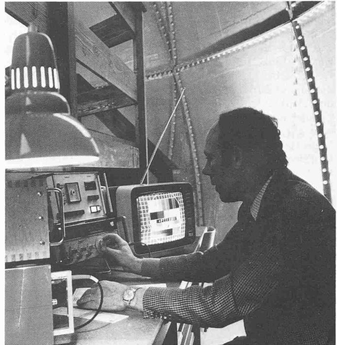
Bild 3. Teilansicht des Messplatzes. Auf dem Bildschirm sind im Testbild deutliche Bildverzerrung eines störenden Handfunksprechgerätes zu erkennen
