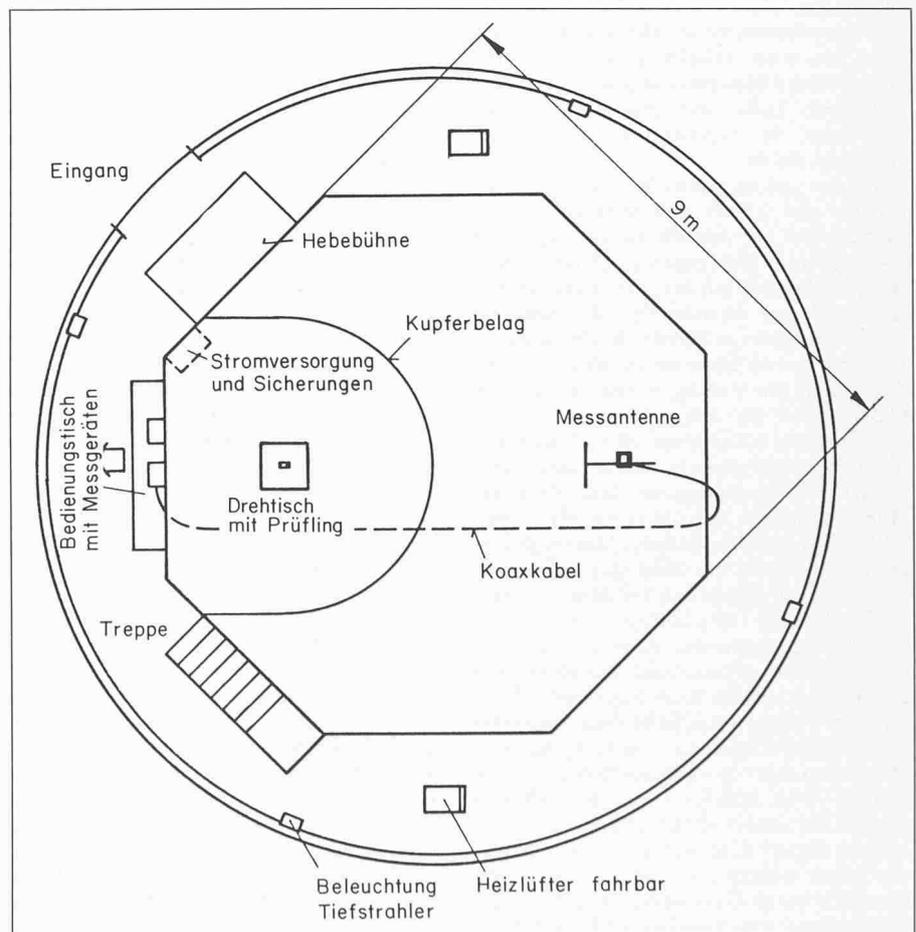
Bild 6. Messplatz: Draufsicht (schematisch)
