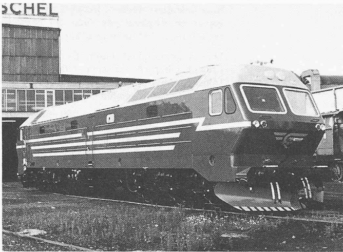
Bild 11. Diesellokomotive Di 4 der Norwegischen Staatsbahn; 3800 PS (2795 kW)
