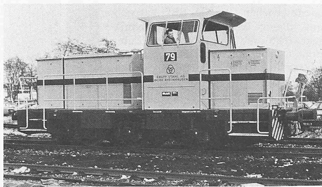
Bild 10. Diesel-Industrie-Rangierlokomotive DE 500, 500 kW Leistung
