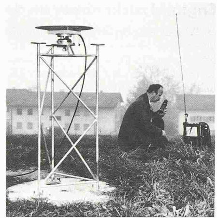
Mit Hilfe einer neuen, satellitenunterstützten Vermessungsmethode wurde die Position von 24 Kontrollpunkten in der Nordschweiz millimetergenau bestimmt. Die Antenne steht genau über einem einbetonierten Vermessungspunkt. Die empfangenen Signale, die von Satelliten ausgesandt werden, werden über ein Antennenkabel an ein transportables Empfangsgerät weitergeleitet
