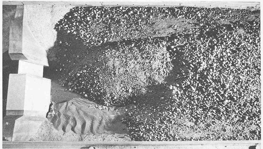
Bild 3. Verlandungssituation nach 9 Stunden (Natur) im Versuch 37. Man erkennt vier verschiedene Verlandungskörper: Zuerst entstand das in der Mitte hinter dem Schlitz in Arenaform abgeschlossene Delta. Darüber hinweg schob sich in einer späteren Phase das hinten (rechts im Bild) sichtbare, breite Delta. Es stiess vor allem entlang dem linken Ufer (unten im Bild) und in der Mitte nach vorne. Zuletzt zog die Strömung nach rechts und brachte auf einem schmalen Delta Material bis zur Sperrenmauer. Der vierte Verlandungskörper entstand links des Schlitzes. In diesem Totwasser (Wasserwalze) lagerte sich feinstes Material ab.
