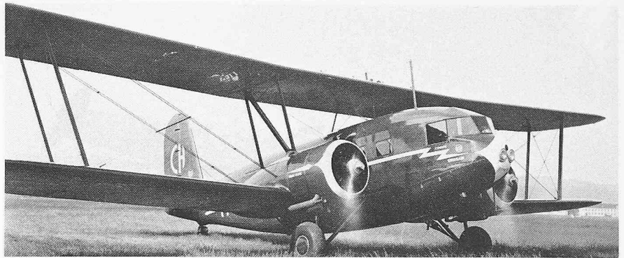
Bild 3. Am 27. Juli 1934 stürzte die im gleichen Jahr angeschaffte Curtiss Condor der Swissair bei einem Linienflug Berlin-Zürich in der Nähe von Tuttlingen (Württemberg) ab. Ursache war das Versagen einer Flügelstrebe infolge Ermüdungsbruchs, das zur Separation eines Flügels führte. Unter den 11 Opfern befand sich die erste Fluggastess Europas, Nelly Diener
