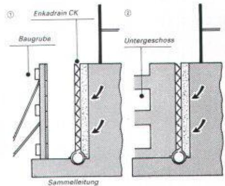
grundes an, ist unverrottbar und leicht zu verarbeiten. Der Einsatz von Enkadrain CK bedeutet: weniger Aushub, keine Abdichtung der Aussenwand, keine Filter- und Sickerschicht, keine Baugrubenverfüllung!
