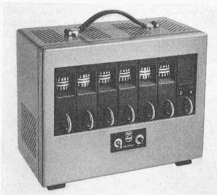
Bild 13. Elektronisches Dekadenzählgerät PT 9700 der Philips AG., Zürich
