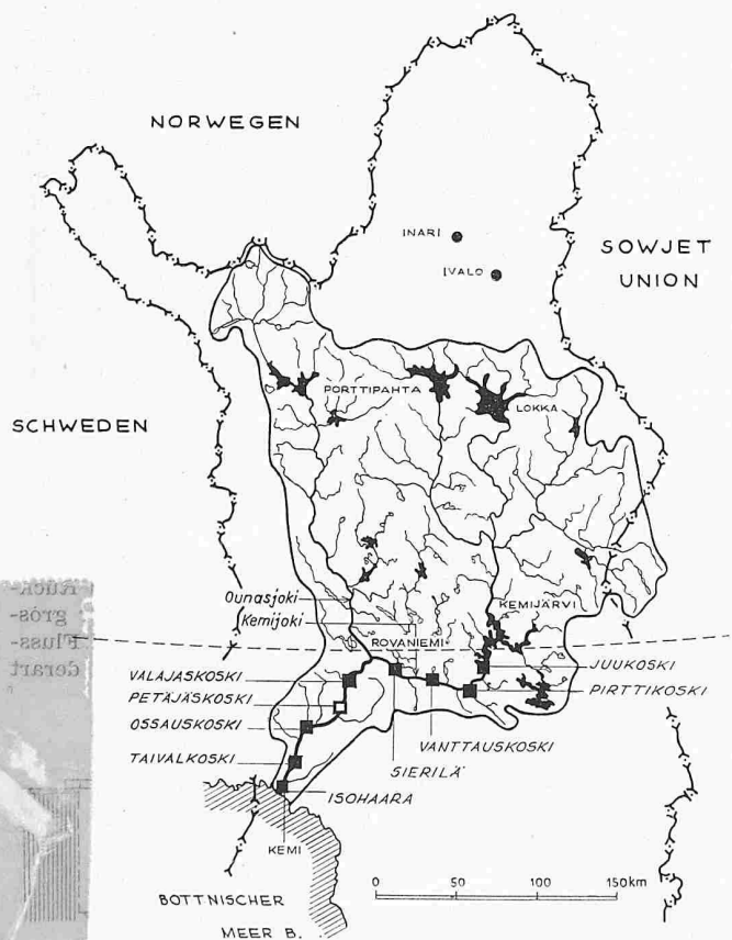
Bild 1. Einzugsgebiet des Kemijoki im Norden Finnlands mit den bestehenden und vorgesehenen Kraftwerken, Masstab 1:5 000 000
