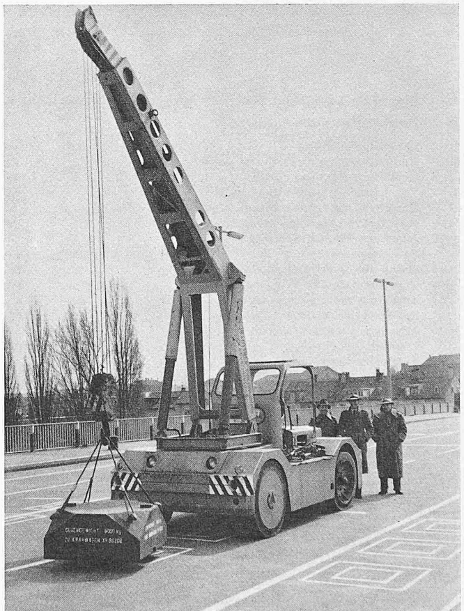
Bild 53. Belastung mit der Vorderachse eines mit einer 6-t-Platte belasteten Kranwagens
