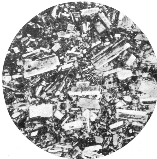
Fig. IV (Thônes, Savoyen). Einsprenglingsreiches Ergußgesteinsbruchstück. Vergr. 40 fach.
