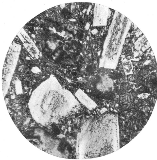
Fig. II (Thônes, Savoyen). Rissige Plagioklase und Hornblendepseudomorphosen in mikrolithenarmer Grundmasse. Vergr. 40 fach.
