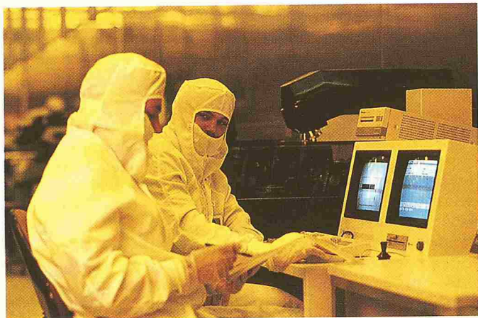
Bild 2. Gerät zur Dimensionsmessung von photolithographisch hergestellten Strukturen auf Siliziumscheiben (Wafern). Ein feinfokussierter Laserstrahl tastet die zu messende Struktur in horizontaler Richtung ab. In Serien von Messungen mit variabler Fokussierung wird das jeweils reflektierte Licht zur Bestimmung der Strukturprofile aufgenommen. Die Auflösungsgrenze beträgt (filmabhängig) 0,5 Mikrometer, bei einer Genauigkeit (nach Kalibrierung) von 10 Nanometer
