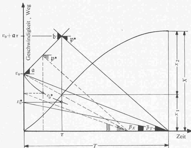
Bild 37.  $v(t)$ - und  $x(t)$ -Diagramm beim Bremsvorgang
