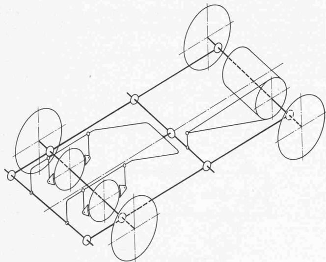
Bild 35. Gelenkig zusammengesetzter Gestellrahmen; links: Rahmenantrieb, rechts: Tatzenlagerantrieb
