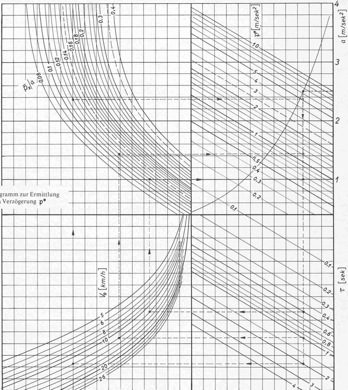
Bild 38. Diagramm zur Ermittlung der effektiven Verzögerung  $p^*$
