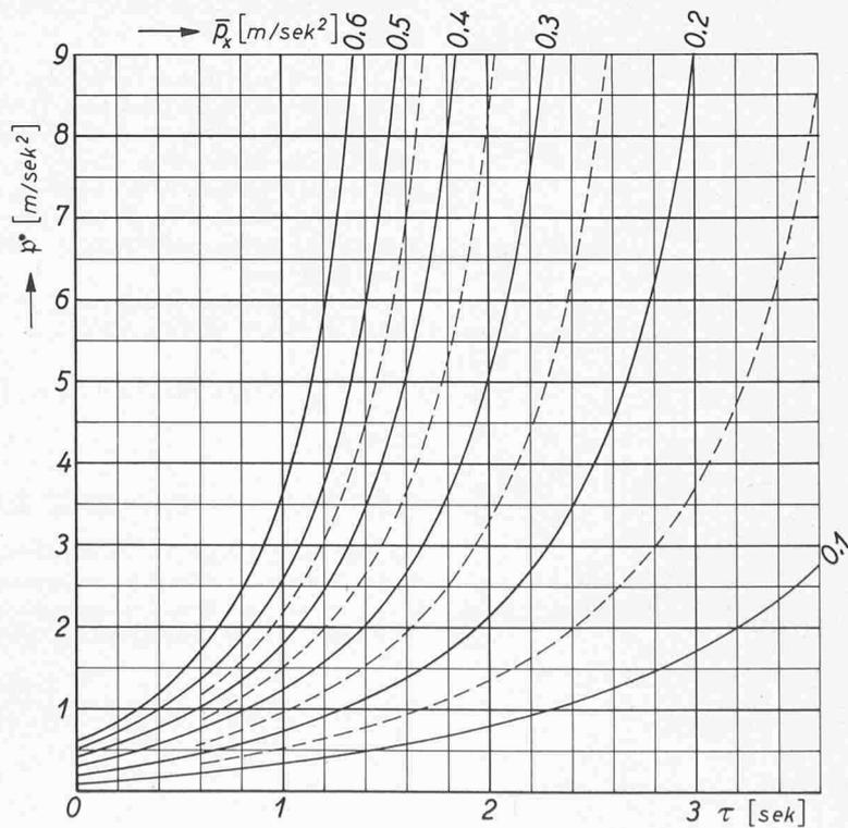
Bild 39.  $p^*(\tau)$ -Kurven bei gegebenen Werten von  $V_0$  und  $\alpha$  und verschiedenen Werten von  $\bar{p}_x$  ( $V_0 = 12$  km/h,  $\alpha = 2,5$  m/s<sup>2</sup>)
