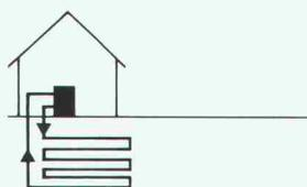
Mit horizontal verlegten Erdkollektoren wird die Sonnenwärme der obersten Erdschicht genutzt. Die Erdkollektoren werden in einer Tiefe von 1,50 m verlegt.
