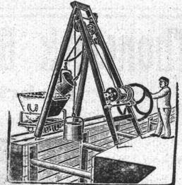
**Fördervorrichtung** mit selbsttätig. Aus- oder Zurückbringung der Fördermasse.
