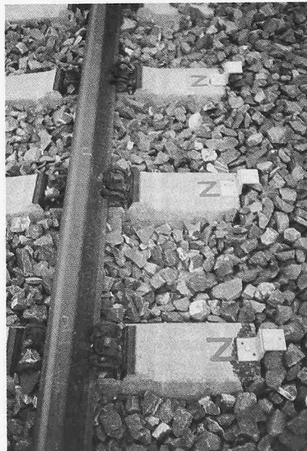
Bild 4. Messpunkte für Einsenkungsmessung
