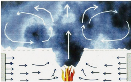
Phase 1: Entrauchungsanlage in Betrieb
