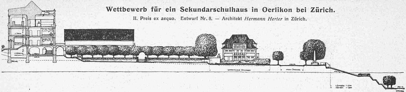
Profil A-B mit Schnitt durch Schulhaus, Turn- und Spielplatz, Vorplatz, Hochstrasse und Abstieg zu Gubelstrasse. — Masstab 1:800.
