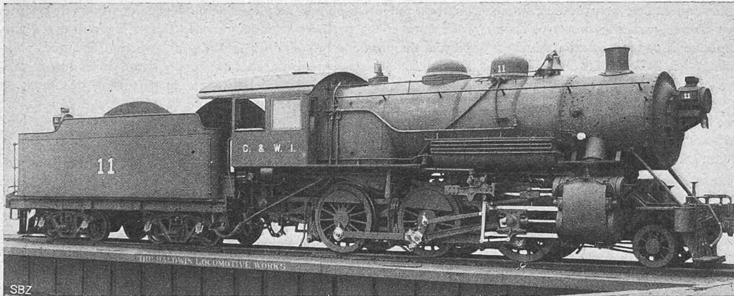
Fig. 1. Locomotive du type „Mogul“ (1 C) du Chicago and Western Indiana Railroad. Construite en 1913 par les Baldwin Locomotive Works à Philadelphia.
