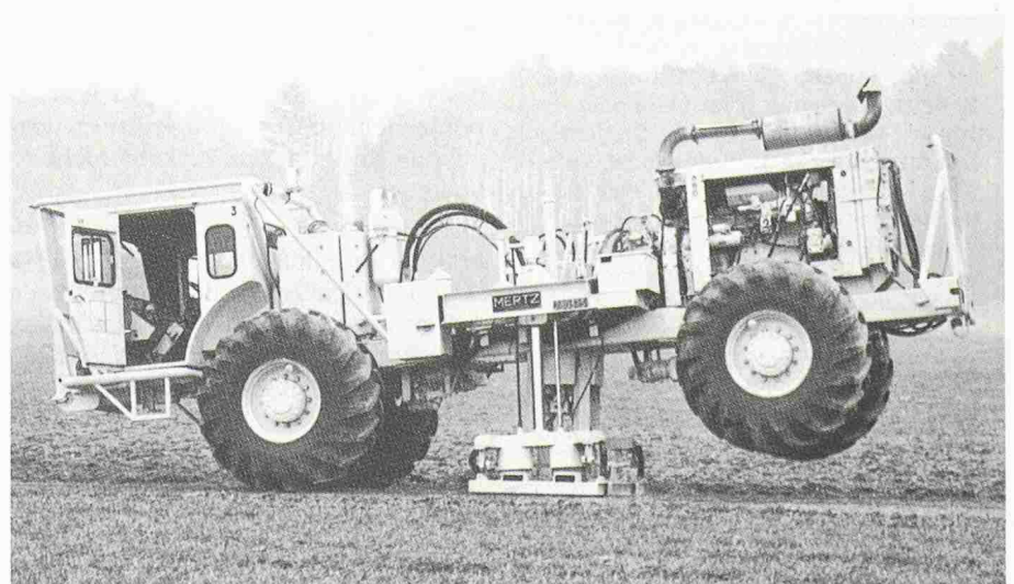
Bild 9. Seismischer Vibrator. 83 Prozent des Vibratorgewichts von 15 Tonnen ruhen in Arbeitsstellung auf der Grundplatte, die hydraulisch in eine modulierte Sinusschwingung von 60 Sekunden Dauer mit einem linearen Frequenzanstieg von 9 auf 45 Hertz versetzt wird.
