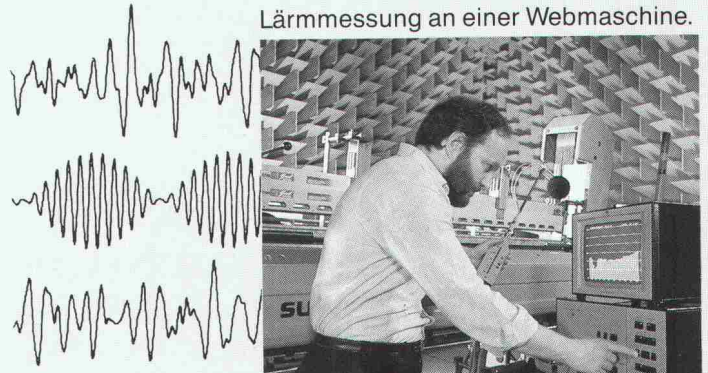
Lärmmessung an einer Webmaschine.
