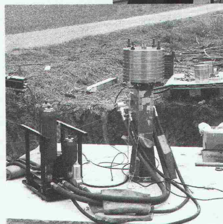
Schwingungserregung einer Fundamentplatte.
