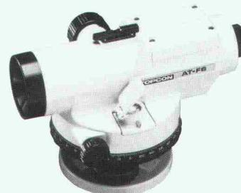
Automatische Nivellierinstrumente TOPCON mit absolut wasserdichtem Fernrohr und sehr stabilem Kompensator, Ziellopter, Horizontalkreis 400° oder 360°. Kürzeste Zielweite 0,5 m. Alu-Schiebestativ. Kunststoffbehälter mit Werkzeug, Senklot und Staubhülle.
