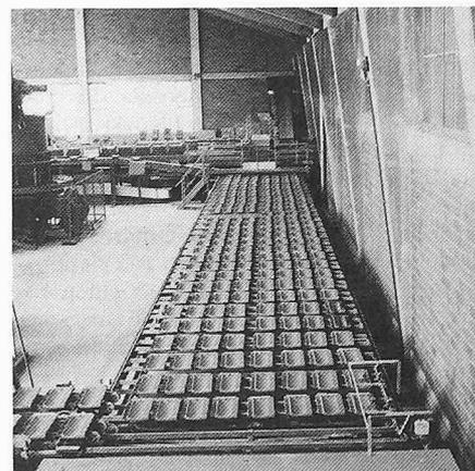
Bild 2. Engoben-Trocknungsstrecke
