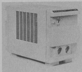
Magnetische Wechselspannungsstabilisatoren sind passive Geräte, die weder Unterhalt brauchen noch irgendeiner Abnutzung ausgesetzt sind. Sie trennen den Verbraucher galvanisch vom Netz, sorgen für konstante 220 Volt und filtern unliebsame Störspitzen aus. Ein
