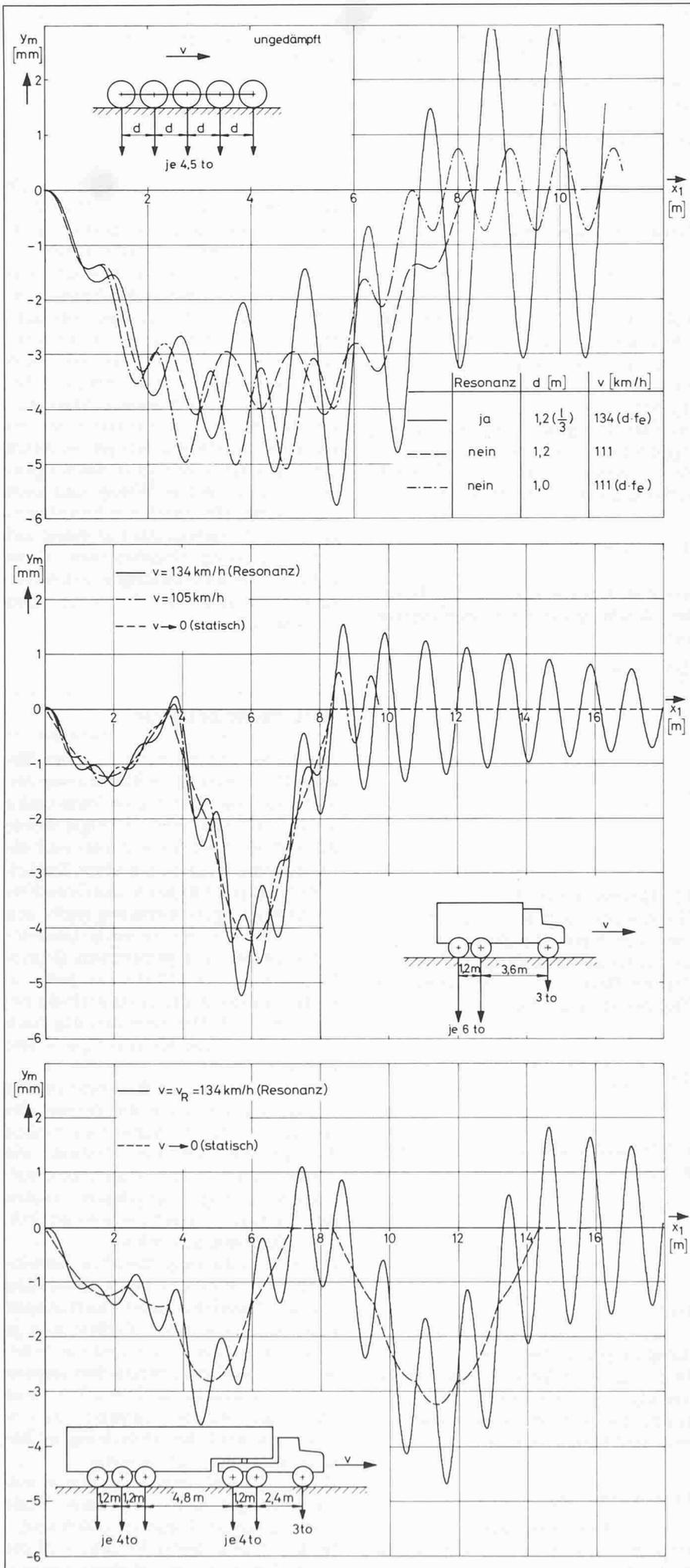
gens mit den angegebenen Achsabständen und Radlasten über die Abdeckung mit der Dämpfung  $a_T = 0,9$  gezeigt. Auch hier tritt bei erfüllten Bedingungen (15) und (16) Resonanz auf. Der dynamische Stosszuschlag  $\phi_0$  beträgt für diesen Fall 24%.
