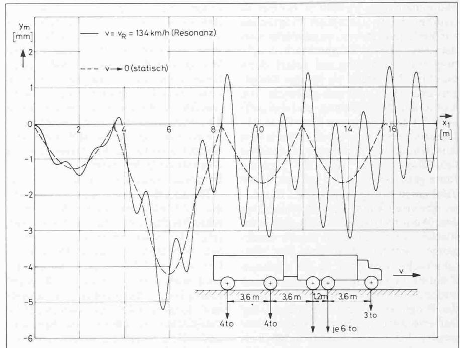
Bild 7. Überfahrt eines sechsachsigen Sattelschleppers. Dämpfung  $a_1 = 0.9$
