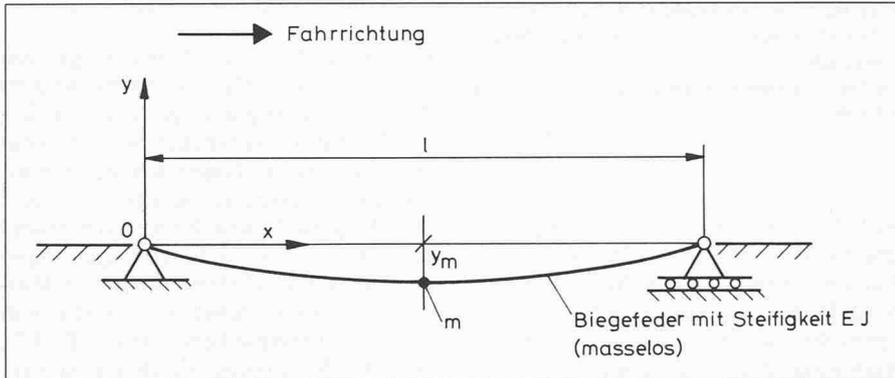
Bild 2. Reduziertes Einmassen-Federsystem
