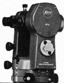
Kern K 1-S. Ingenieurtheodolit mit Skalenablesung
