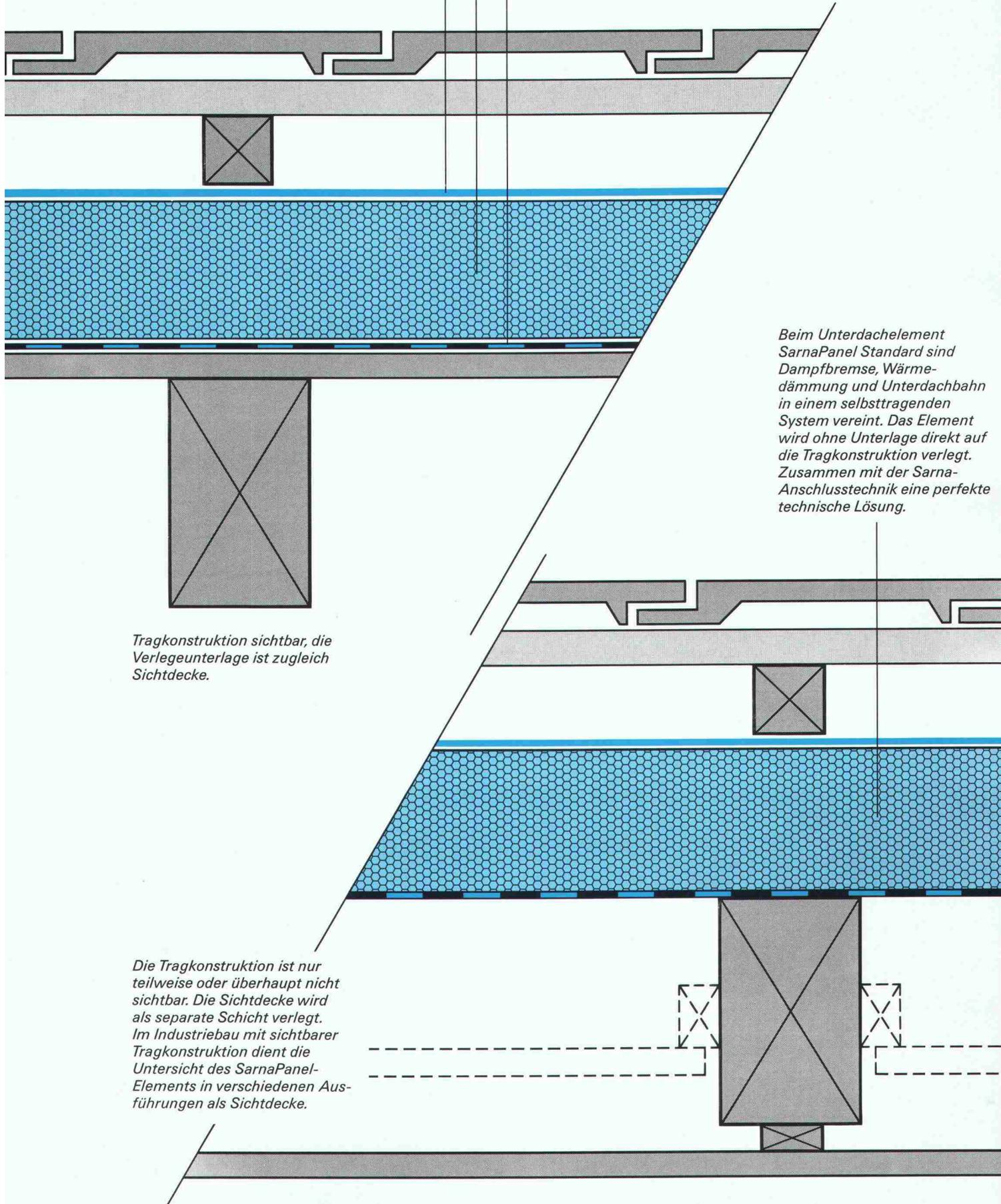
Beim Unterdachelement SarnaPanel Standard sind Dampfbremse, Wärmedämmung und Unterdachbahn in einem selbsttragenden System vereint. Das Element wird ohne Unterlage direkt auf die Tragkonstruktion verlegt. Zusammen mit der Sarna-Anschlusstechnik eine perfekte technische Lösung.
