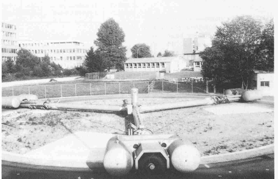
Bild 2. Rundlaufanlage des ISETH bei der EMPA in Dübendorf (Ø 32 m; v_{max} 80 km/h; Radlast 50...80 kN)
