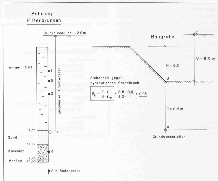
Bild 2. Schematischer Schnitt durch die Baugrube Zürich. Die durchgeführte Gleichgewichtsbetrachtung zeigt, dass die Baugrube ohne vorgängige Druckentlastung eine kleinere Sicherheit  $F_H$  als 1 aufweist, also instabil ist
