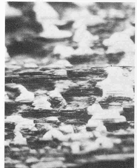
Bild 1. Oberflächliche Holzerosion durch Solarstrahlung, Bläuepilze und Regen
