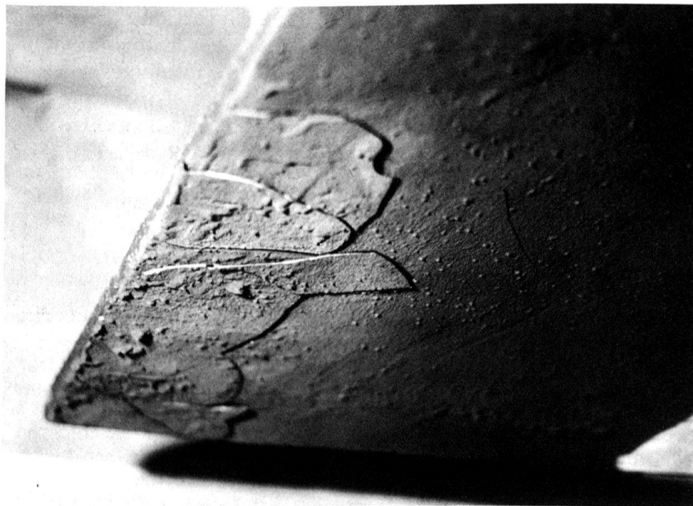
7 Danni provocati dalla tecnica usata dall'artista: erronea ancoratura dello strato pittorico al supporto. L'artista ha steso uno spesso strato di materia epossidica su un fondo ricoperto di una mano di pittura magra; la natura pulverulenta di questa preparazione ha impedito allo strato epossidico di attaccarsi tenacemente al fondo. Lo stacco di vasti frammenti è stato originato dalle tensioni causate dalle contrazioni del supporto ligneo. L'opacità della superficie rende estremamente problematica la fissazione dei frammenti. Yves Klein: «Le Monochrome» 1961. Resina epossidica su legno compensato. 194x422 cm. Dettaglio.
