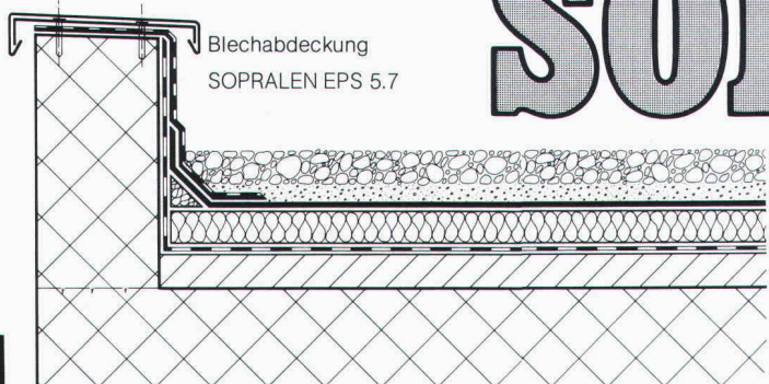
Schutzschicht SOPRALEN EJ 3.5 + EV 3.2 Wärmedämmschicht Dampfsperre
