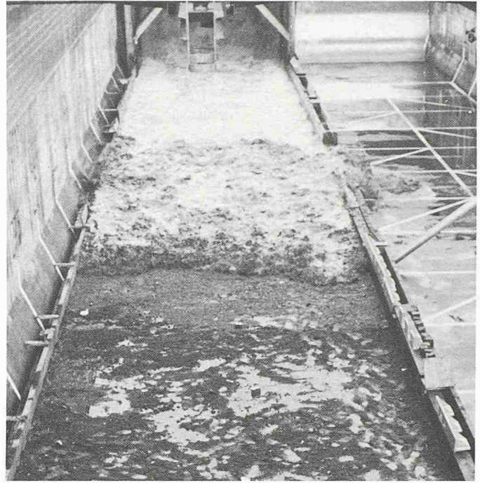
Bild 9. Spülvorgang mit Spülkasten in Natur bei derselben Verschmutzung. Der aufwühlenden Frontwalze folgt eine Nachlaufströmung, die zusätzlich Schmutzstoffe mitreisst
