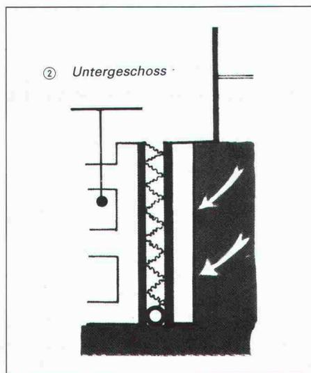
einem dreidimensional strukturierten Sickerkörper aus drahtartigen Polyamid-Fadengelegten mit einer vollflächig aufgeschweissten Spinnvlies-Filterlage aus Polyester auf der einen und einer betonerdichten PVC-Schicht als verlorene Schalung auf der anderen Seite.
