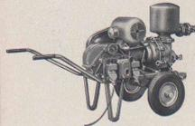
„JUNG“-Doppelmembran-Baupumpen (DBP) stationär oder auf luftbereifter Karre montiert. Der Antrieb erfolgt durch Elektro-, Diesel- oder Benzinmotor, für den Einsatz bei Kanalisations- und Schachtarbeiten, zur Trockenhaltung und Absenkung von Baugruben, zur Grund- und Hochwasserbeseitigung mit stündlichen Leistungen max. 30 cbm
