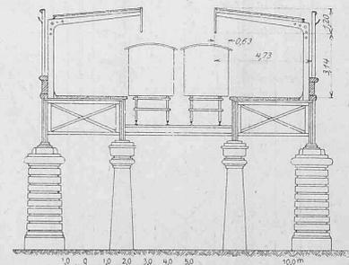
Abb. 4. Hochbahnstation. — Querschnitt. Masstab 1 : 300.
