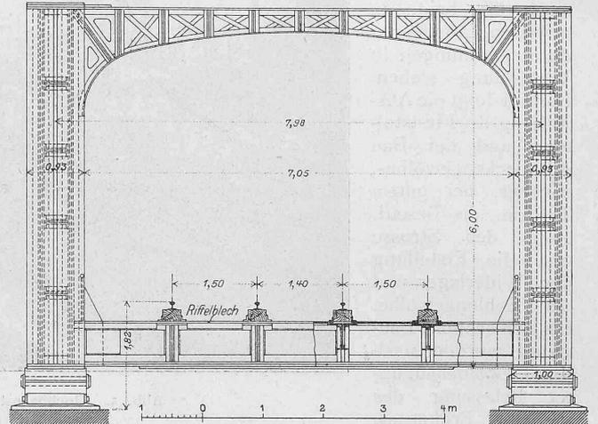
Abb. 9. Stirnansicht des Trägers von 75,25 m Spannweite.
