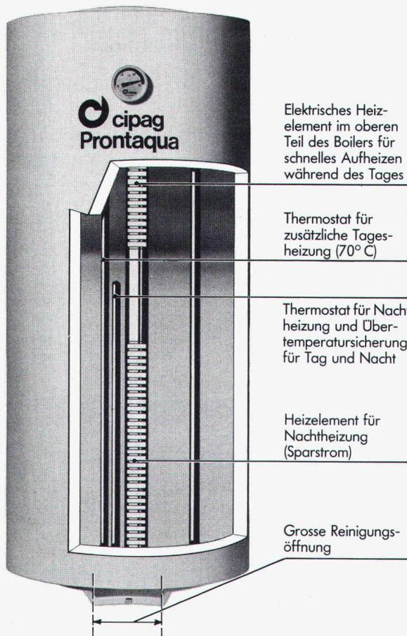
Elektrisches Heizelement im oberen Teil des Boilers für schnelles Aufheizen während des Tages
