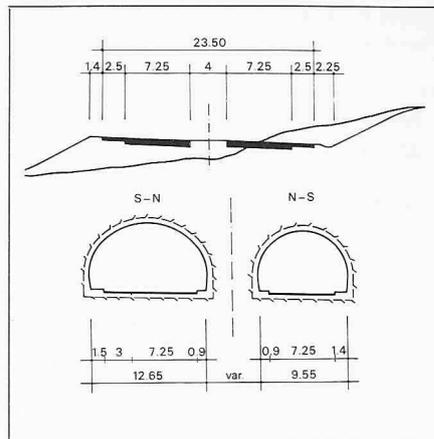
Bild 3 (oben). Normalprofile der N2 in der Leventina
